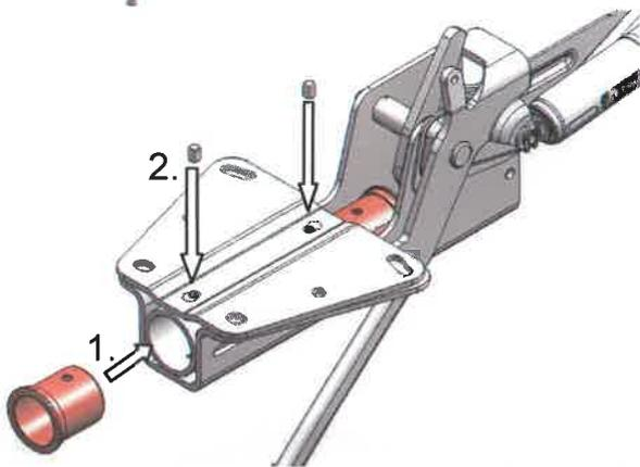
2) Die Führungslager bis zum Anschlag in das Gehäuse einpressen.
