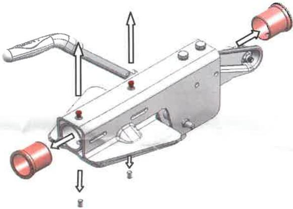
1) Schmiernippel aus dem Gehäuse entfernen.
