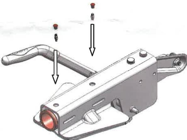
Zugstange leicht fetten und einsetzen. Über die Schmiernippel mit handelsüblichem Schmierfett (z. B. Lithium Seifenfett) gründlich nachschmieren.
